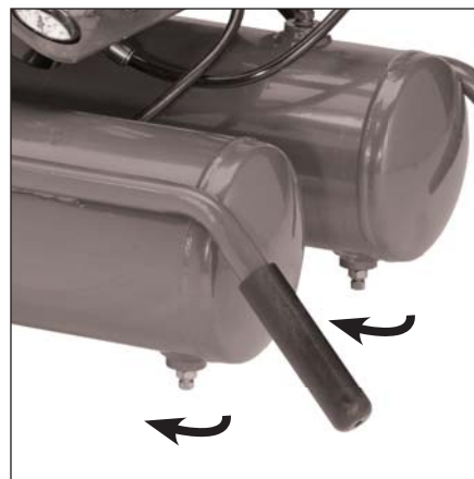
Figure 5 - Drain du réservoir
